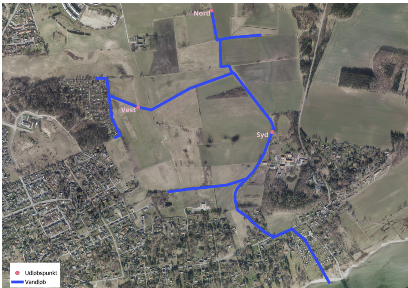
Figur 4 Nye regnvandsudløb fra bassinerne til Ullerup Å.
